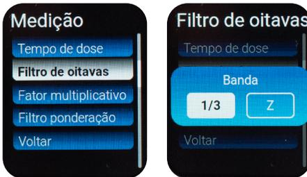
\*\*\*Você pode selecionar 1/1 ou 1/3 e em seguida escolher qual eixo fará a medição, entre os eixos X, Y e Z.
