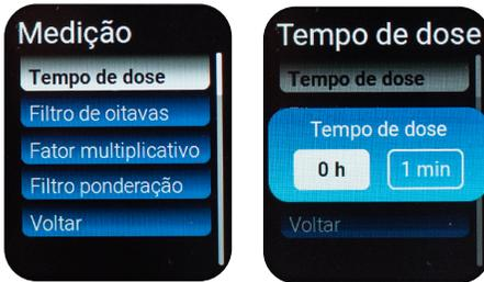
\*\*\*Limite de configuração mínimo de 01 min e máximo de 10 h 59 min.
