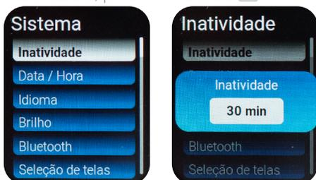
\*\*\*Você pode configurar o tempo de inatividade entre 01 e 30 minutos. Após o tempo de inatividade, se não estiver realizando medição, o equipamento desliga automaticamente. O modo stand by caracteriza-se por operação normal, porém com tela desligada.
