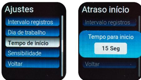
\*\*\*Configure entre os limites mínimo de 01 segundo e máximo de 600 segundos.
